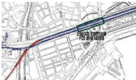
Túneles Independientes F.C. y METRO (alternativa).
